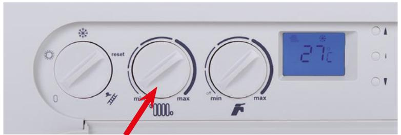
**!** Bei aktivierter witterungsgeführter Heizungstemperatur ändert sich die Bedeutung der Funktion des mittleren Drehknopfs auf dem Bedienfeld des Kessels. Mittels des gekennzeichneten Drehknopfs wird in diesem Fall die Verschiebung der Heizkurve eingestellt (im Bereich von  $\pm 15\text{ °C}$  von der vom Servicetechniker eingestellten Heizkurve).
